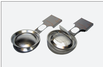
写真2. 破裂前と破裂後のHOV型ラプチャーディスク
