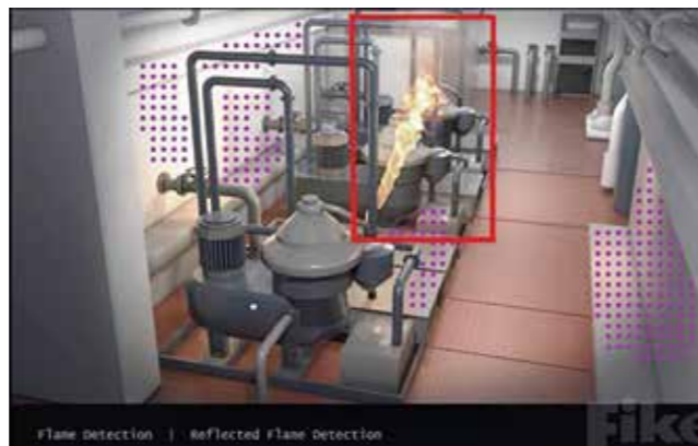
写真2. SigniFireが火炎を感知した様子。 火炎は赤い枠で、反射している炎はピンクのドットで表示されます。(機械室に設置)
